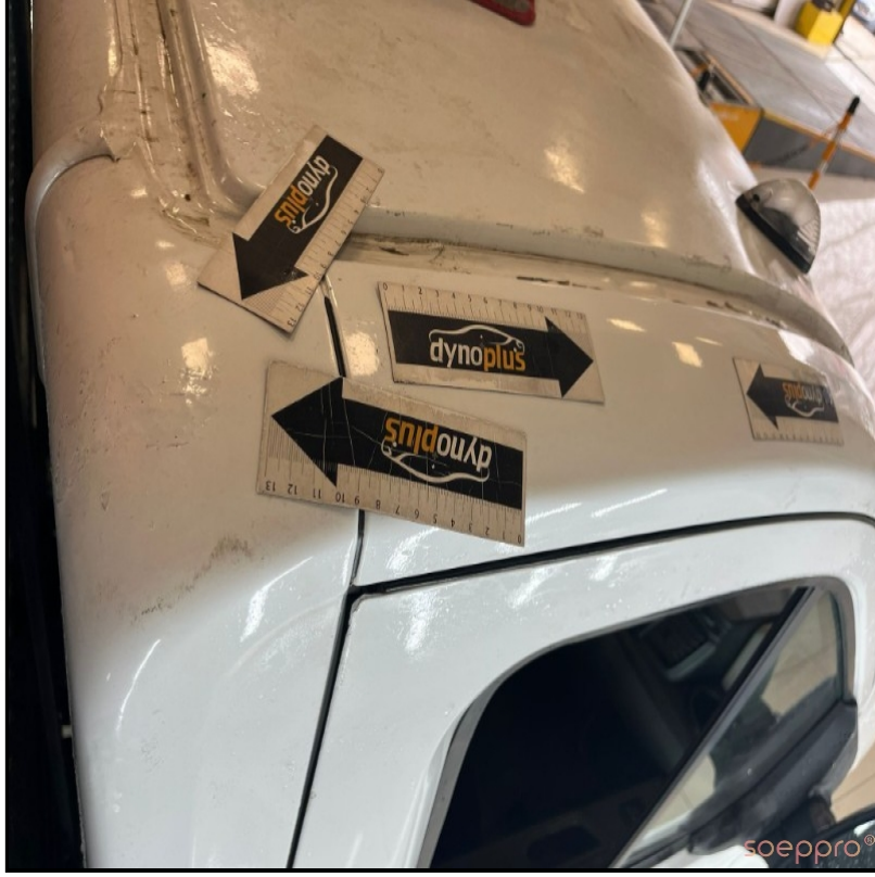
Sağ ön kapının üst kısımlarında boyasız göçük düzeltmeler mevcut
