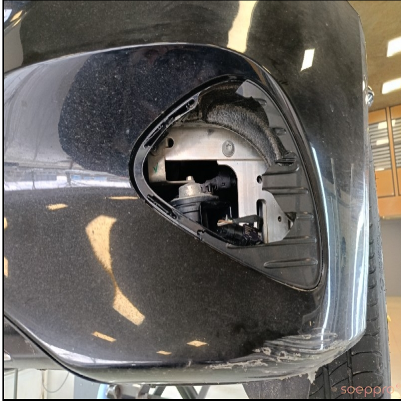
Ön tamponda plastik parça kırık
