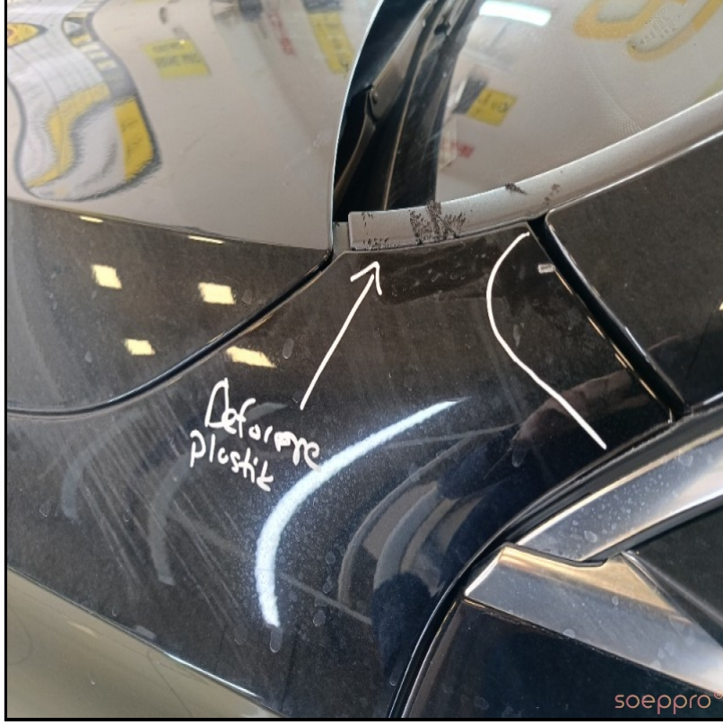
Sol ön çamurluk kaplamasında deforme
