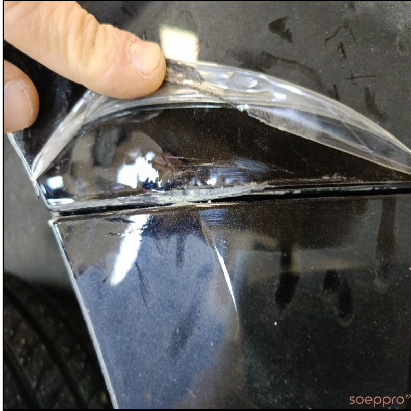
Sol arka çamurlukda kuru onarım mevcut
