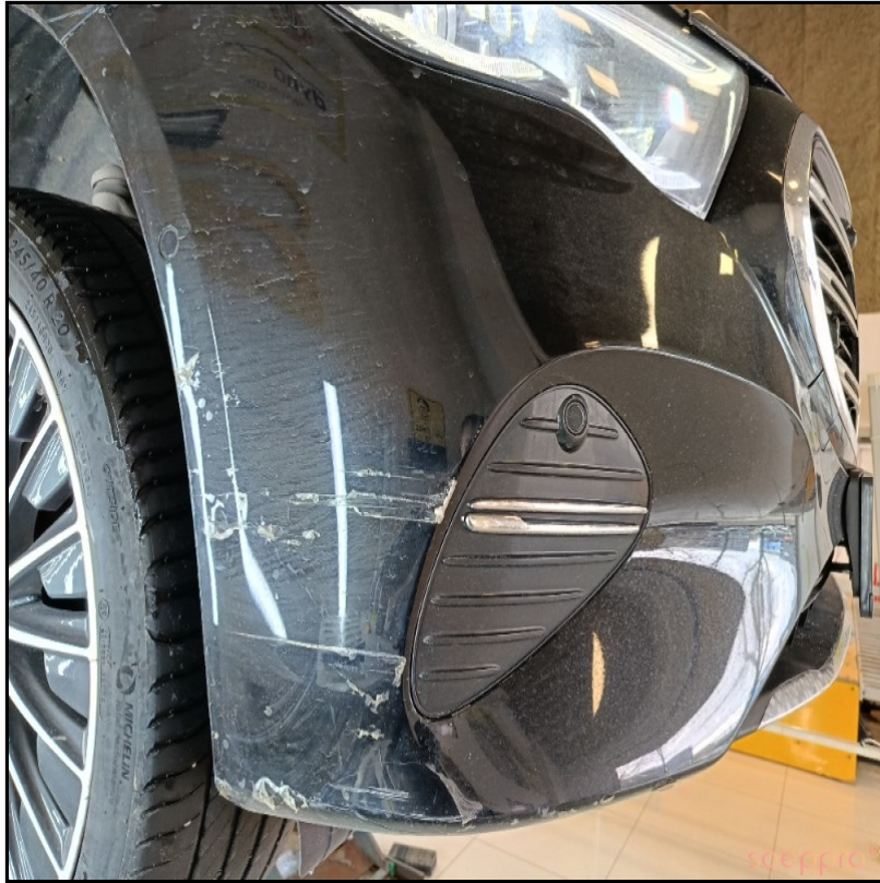
Ön tamponda sürtme izleri var
