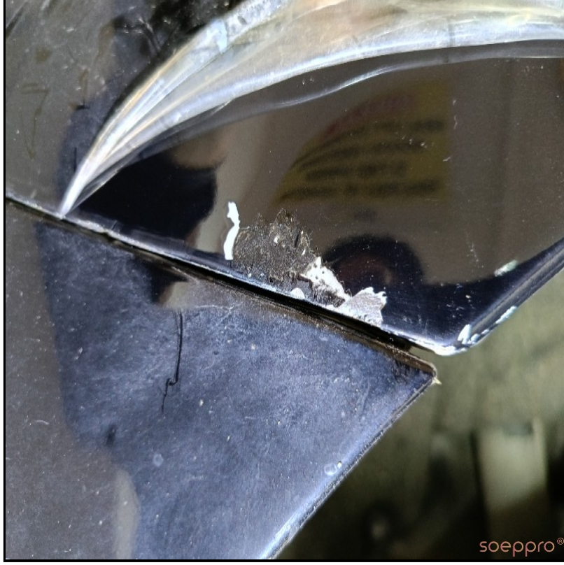
Sağ arka çamurlukda boya atığı mevcut
