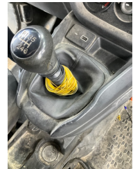
Şanzıman, Vites körüğü > Deforme Olmuş
