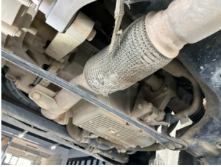
Egzoz sistemi, Esnek boru > Hasarlı
