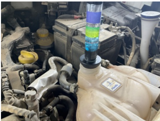
Motor, Silindir kapağı contası > Test Sonucu
