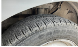
Lastik, sol ön > Deforme Olmuş
