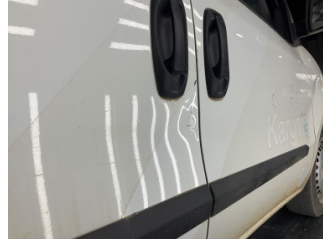
Kapı, sağ arka, Kapı, sağ arka > Ezik
