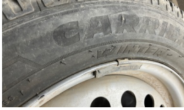
Lastik, sol ön > Deforme Olmuş
