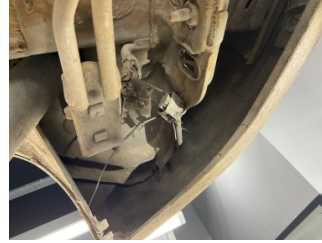
Elektrik donanımı/Pano, Kablo demeti > Onaysız
