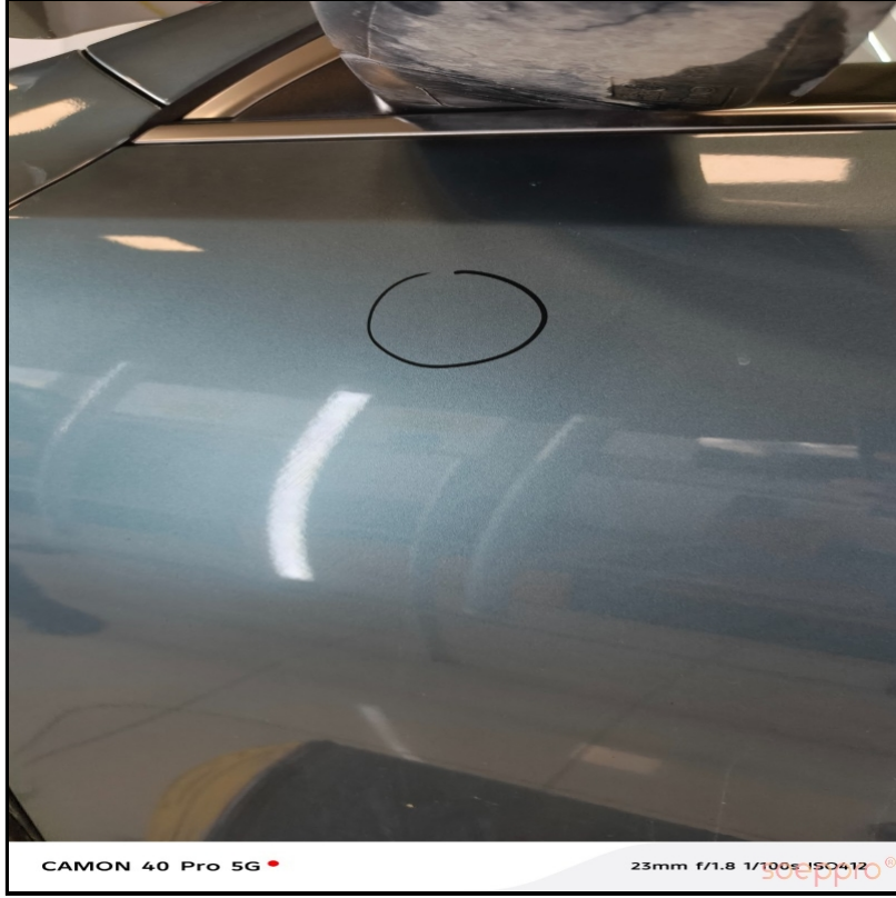
Sol ön kapıda hafif göçük var
