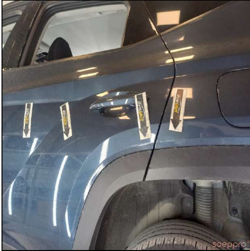
Sol arka kapı sol arka çamurluk rötuş boyası ve ezikler mevcut
