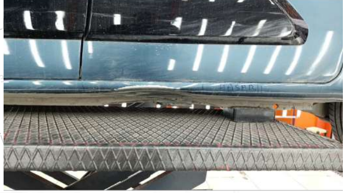
Sol marşbiyel hasarlı
