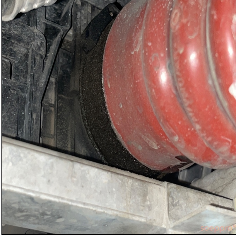
İnter kolları borusunda yağ kaçağı var
