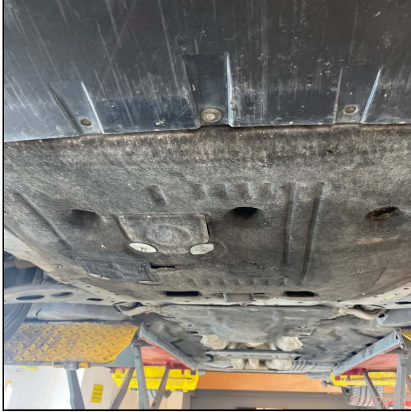
Motor alt muhafazasında deformeler var
