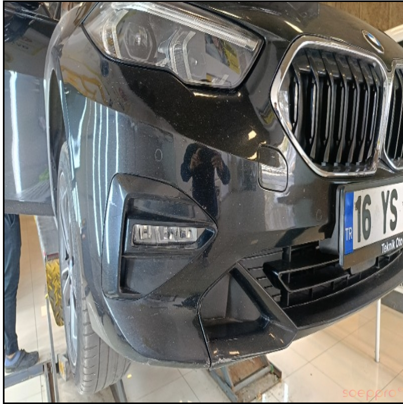
Ön tamponda deforme be boya catlamları mevcut
