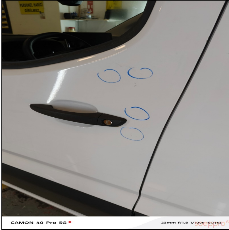
Sol ön kapıda göçükler var
