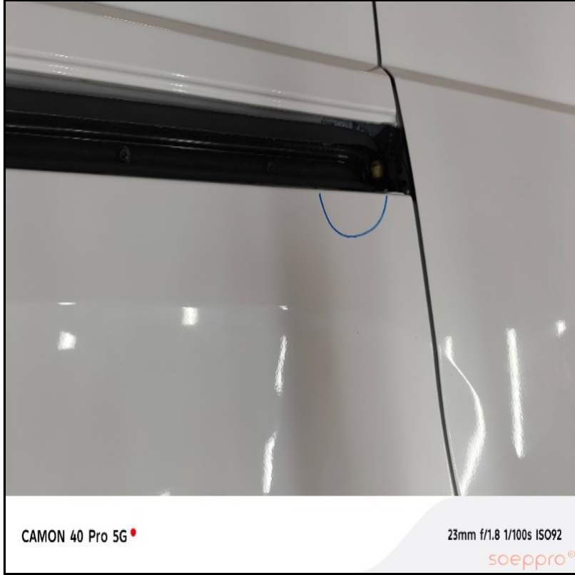
Sağ arka çamurluk da göçük var
