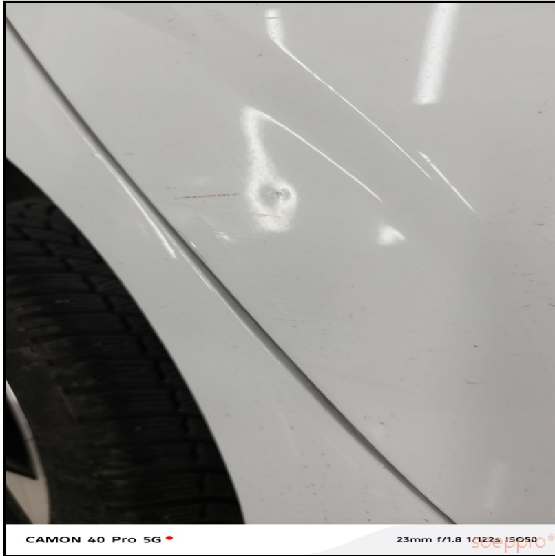
Sağ arka kapıda göçükler var
