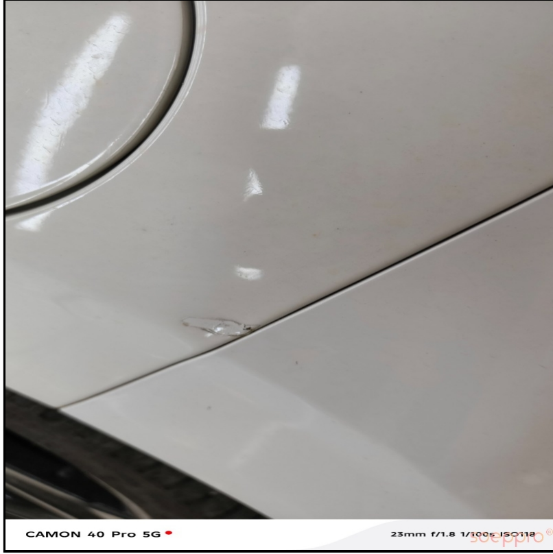
Sol arka çamurluk filminde deforme
