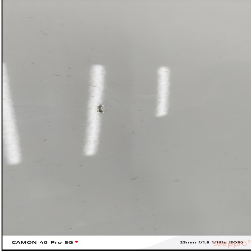
Sağ ön kapı filminde deforme var
