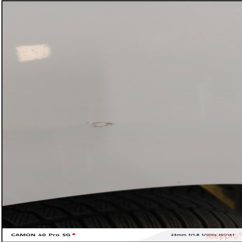
Sağ ön çamurluk filmde deforme
