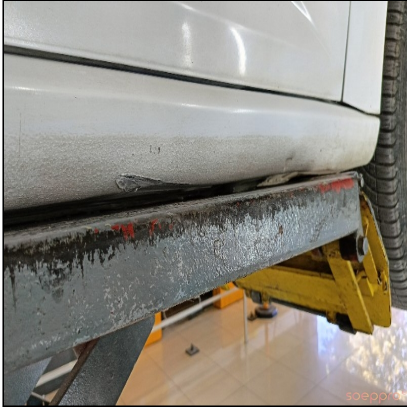
Sağ marşpiyel hasarlı
