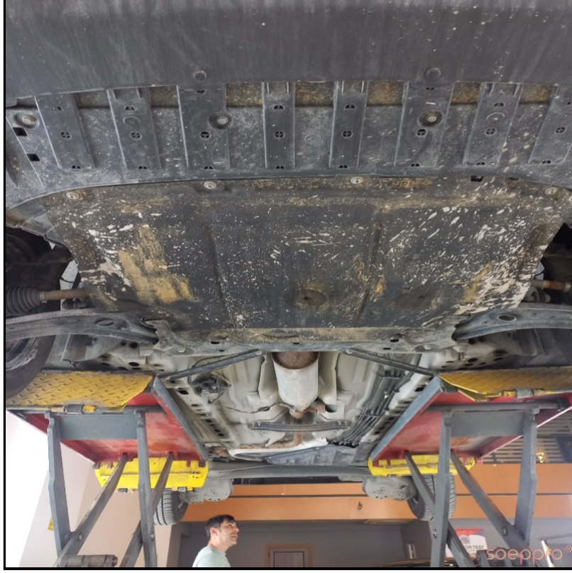
Araç alt kısımlarda oksitlenmeler mevcut ve alt muhafazada deformeler var
