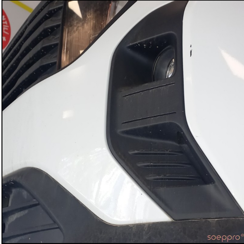
Ön tamponda boya deformeleri var
