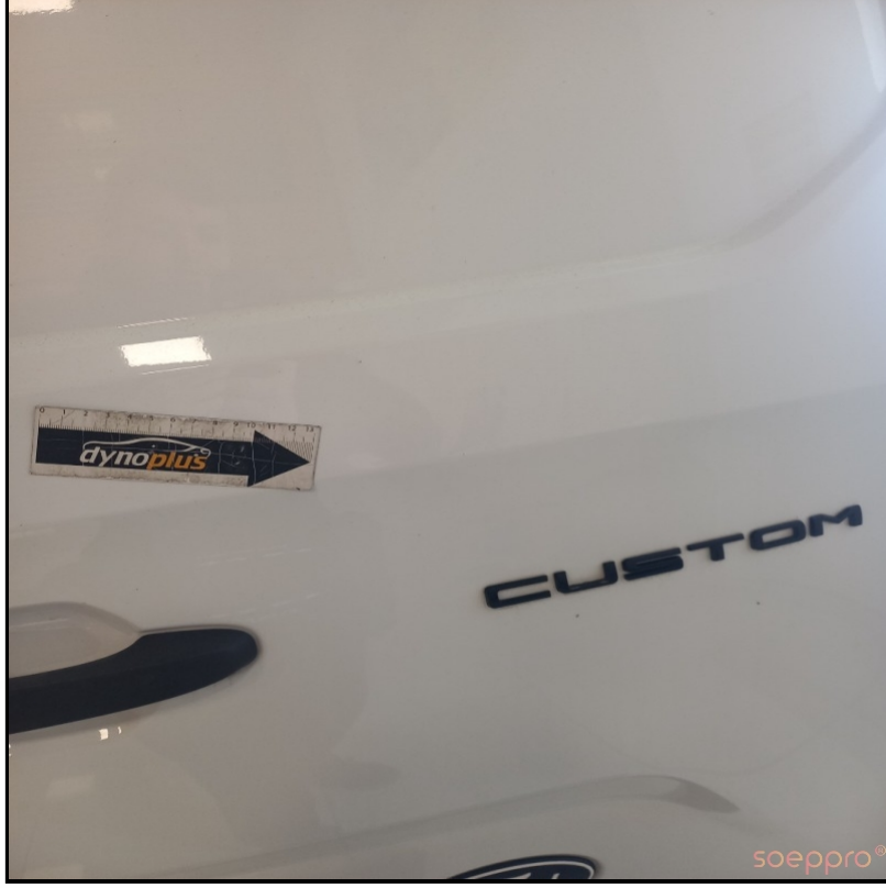
Bagaj kapağında göçük mevcut
