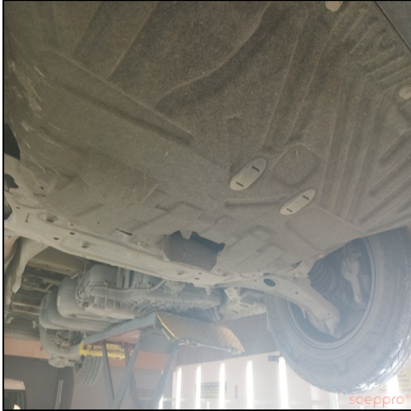
Alt muafazada deforme mevcut
