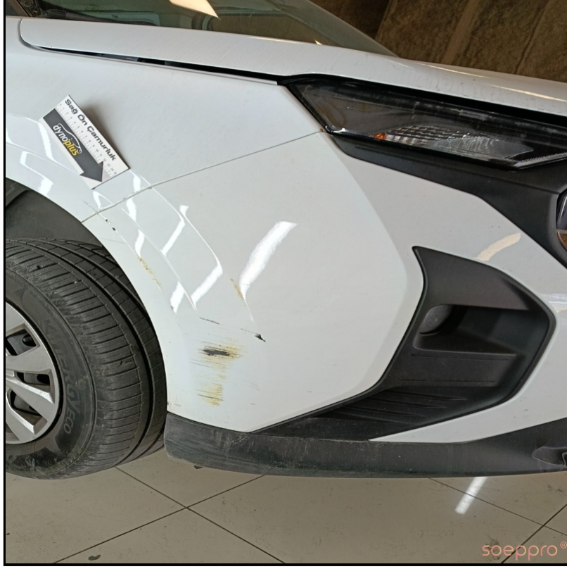
Ön tamponda sürtme izleri ve camurlukta sürtme izleri
