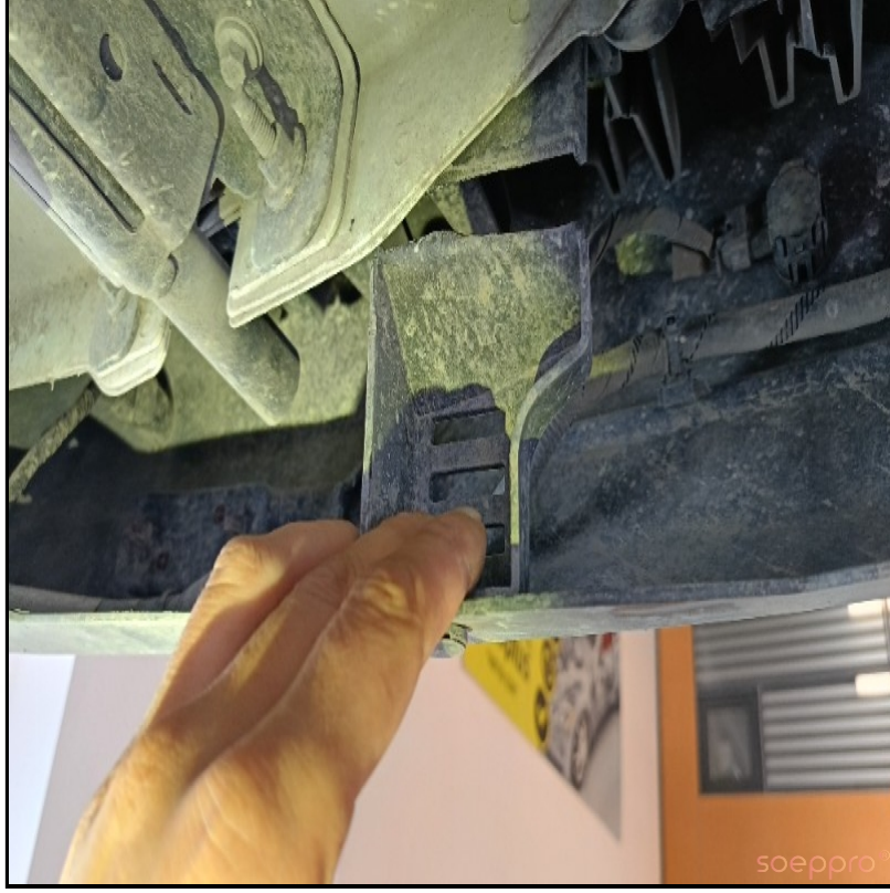
Arka tampon alt plastiği hasarlı
