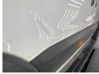
Kapı, sol ön, Kapı, sol ön > Ezik
