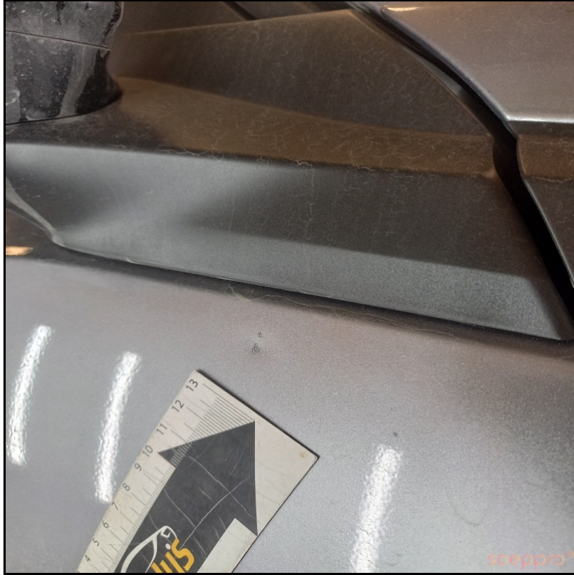
Sol ön kapıda göçük mevcut
