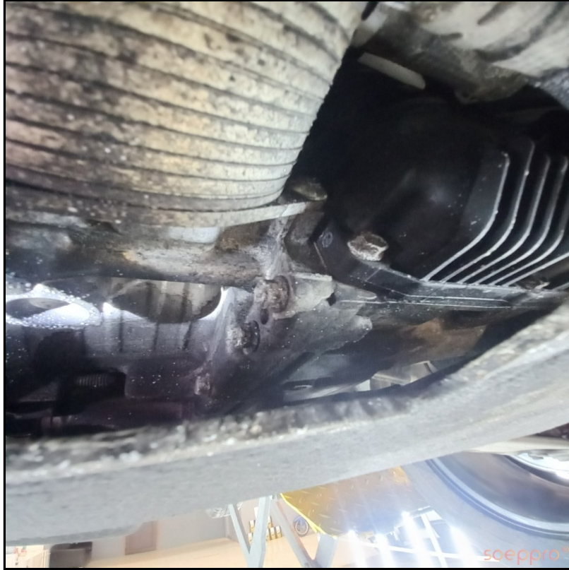
Şanzıman kartelinde yağ terletmesi ve adblue kaçak izleri karlanmalar var
