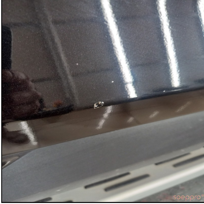
Sag arka kapi kaplamada deforme ve hafif gocuk var
