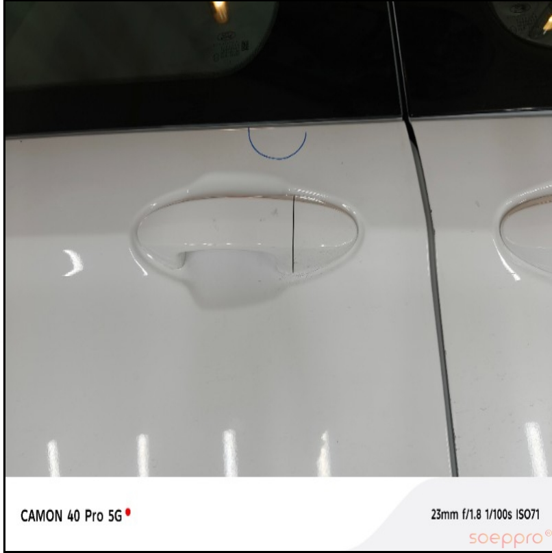
Sağ arka kapıda göçük var
