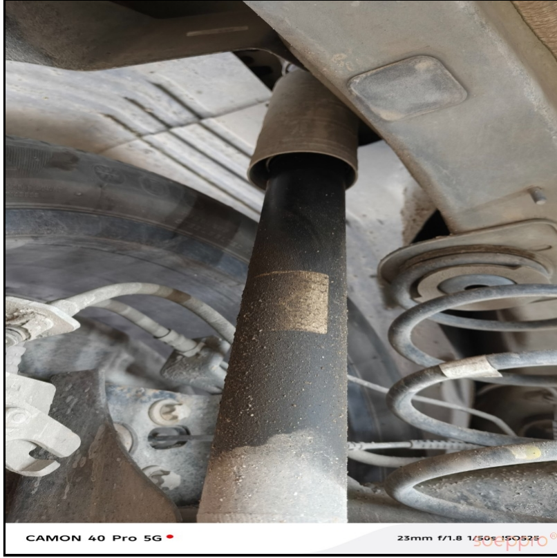
Arka amortisörlerde yağ kaçağı
