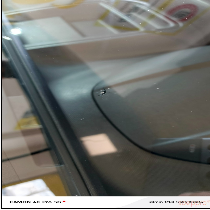
Ön cam çatlak
