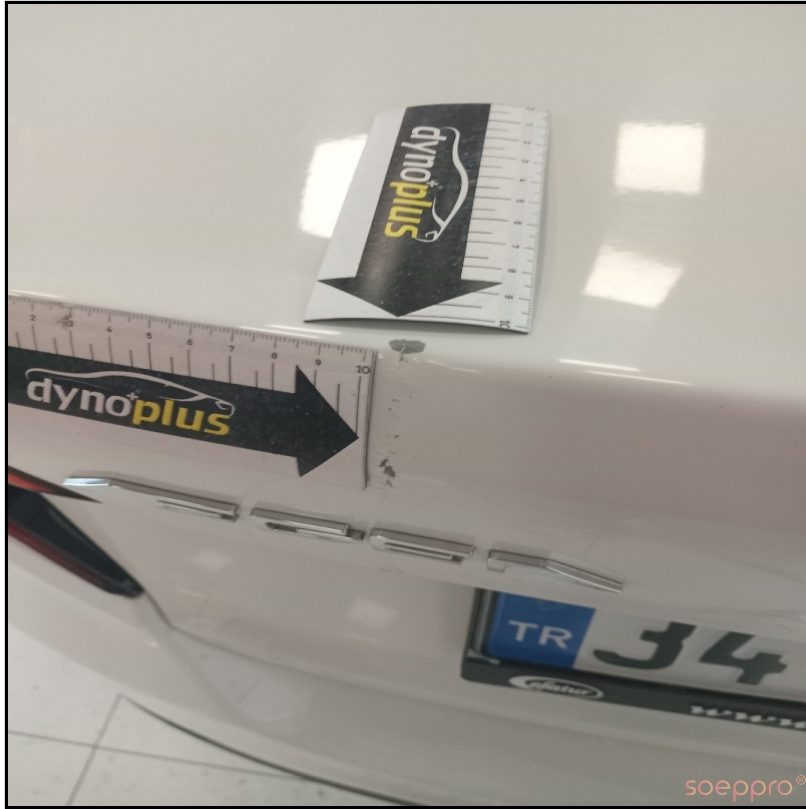
Bagaj kapağı kuru onarım ve lokal var
