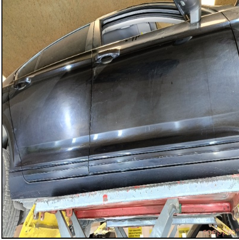
Sağ kapı alt plastikleri deforme
