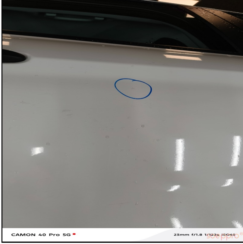
Sol arka kapıda göçük var
