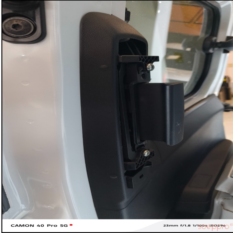
Sağ arka kapı iç plastik tutucu sabit değil
