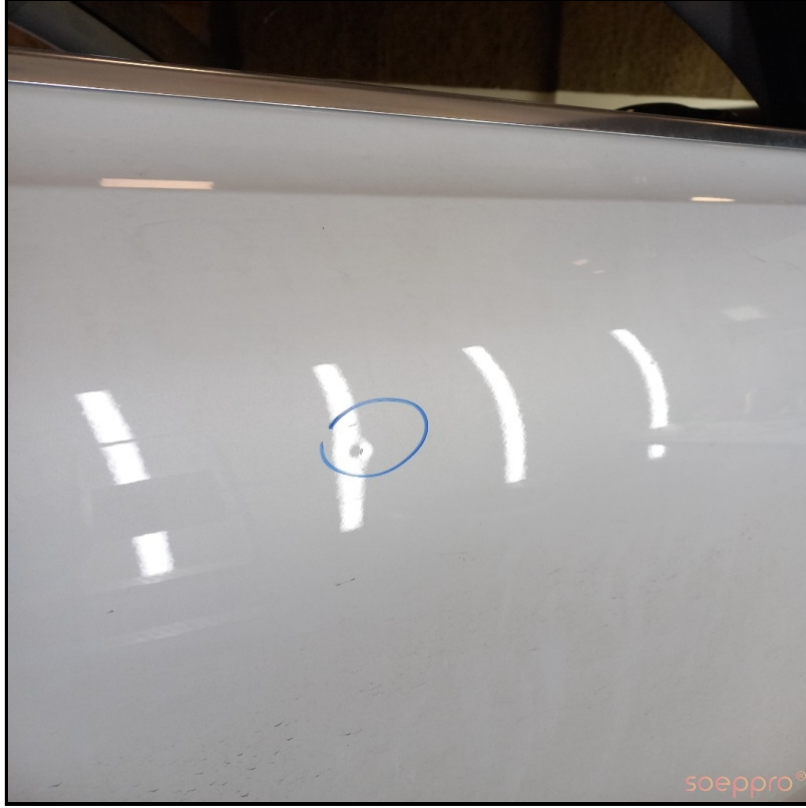
Sağ on kapıda hafif göcük var
