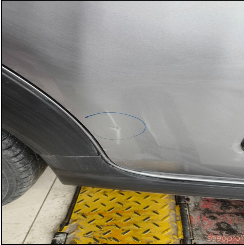
Sağ arka kapıda göçük var
