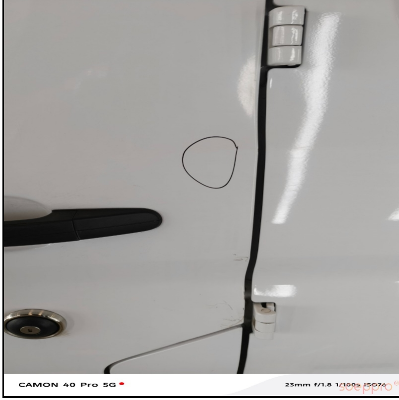
Sol ön kapıda hafif göçük var
