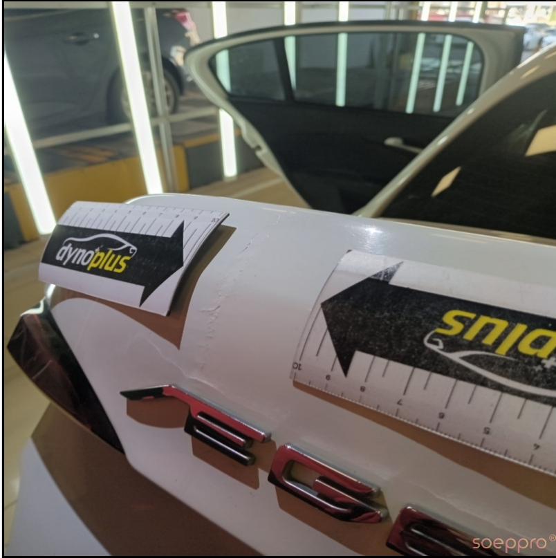
Bagaj kapağında kuru onarım ve rutuş var
