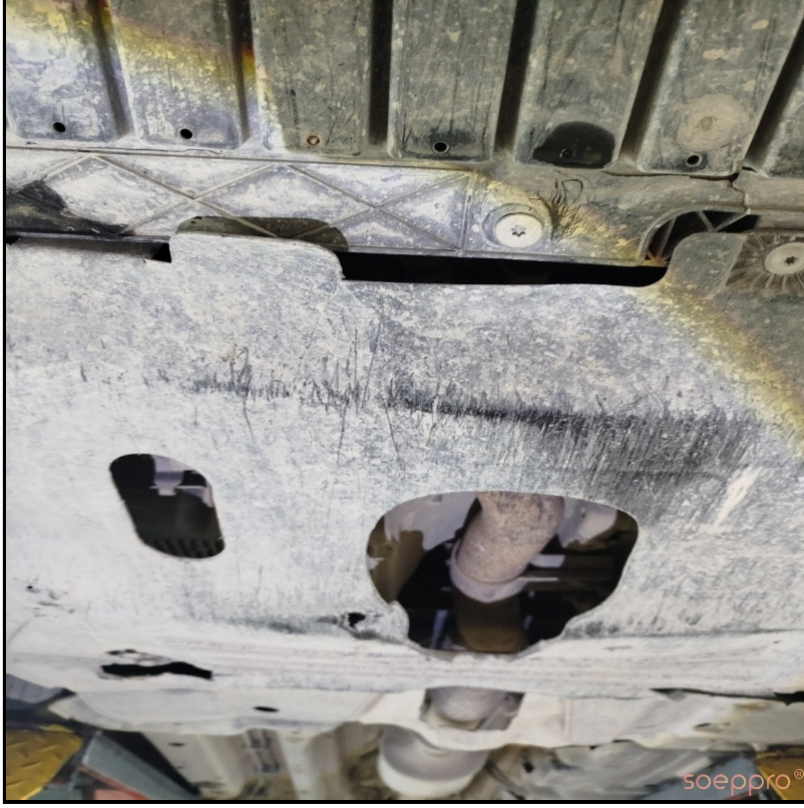
Alt plastik muhafazada deforme mevcut
