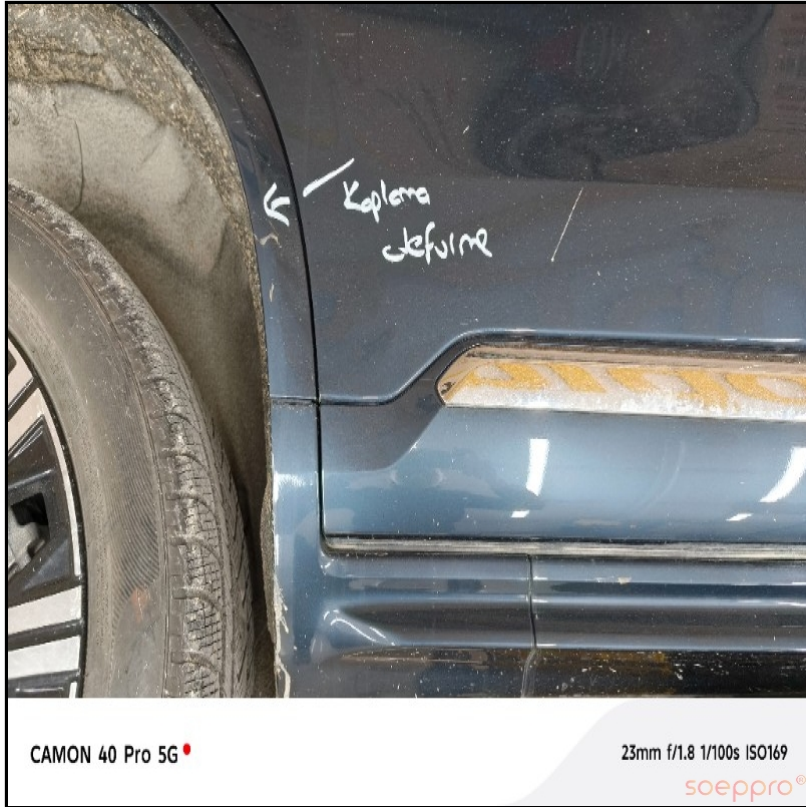
Sağ arka çamurluk kaplamada deforme mevcut
