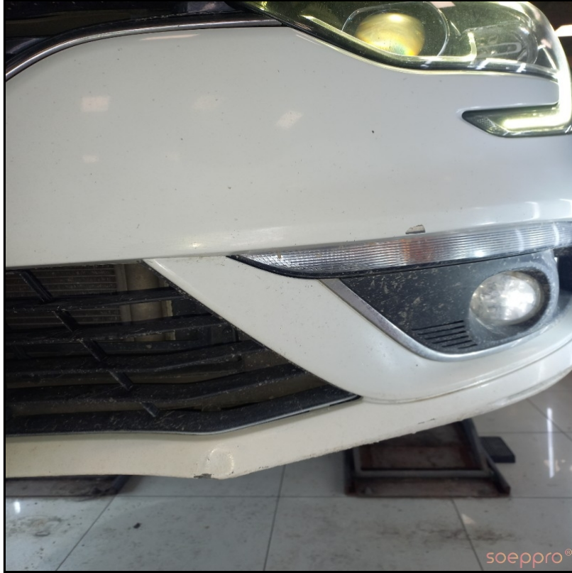
Ön tamponda deformeler boya ve macun atıkları var var
