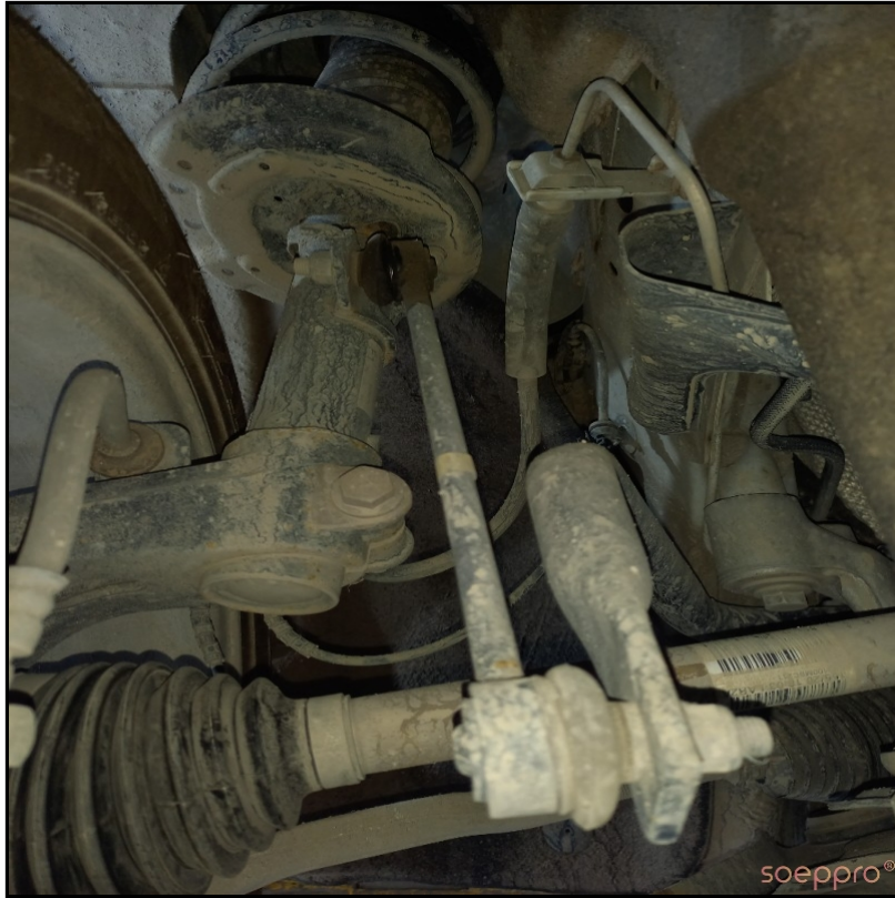
Sağ sol Z rotlarında yıpranmalar var
