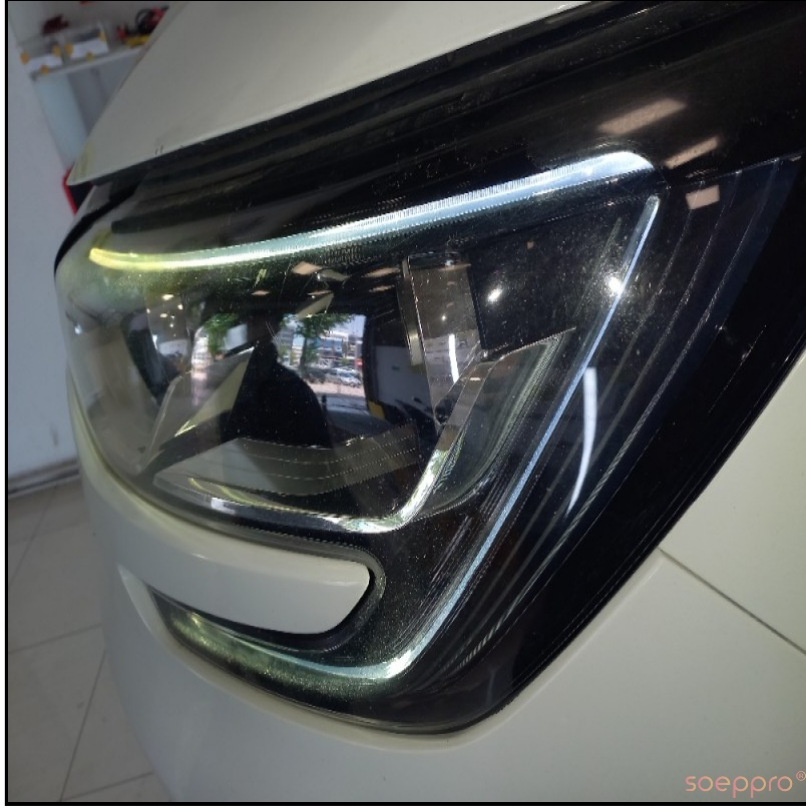
Ön farlarda solmalar deformeler var
