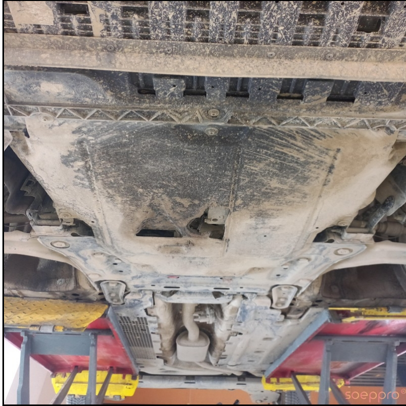
Aracın altı yoğun çamurlu ve muhafazalarda deformeler var
