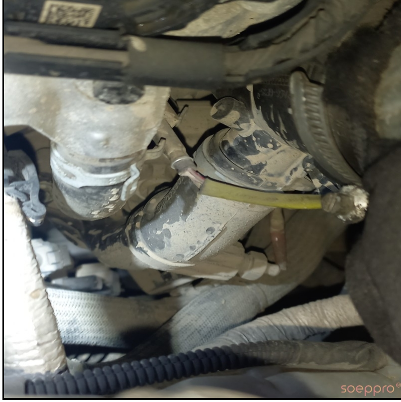
Termostat bölgesinde su kaçaqları var
