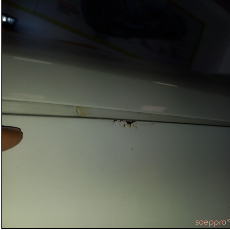
Sol plastik ön çamurlukta kırık ve deforme var
