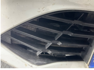
Tampon, ön, Ön tampon ızgarası > Hasarlı
