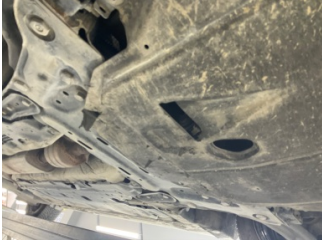
Motor, Alt muhafaza > Hasarlı
