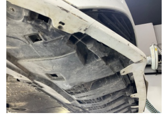
Tampon, ön, Tampon koruyucu orta > Hasarlı
