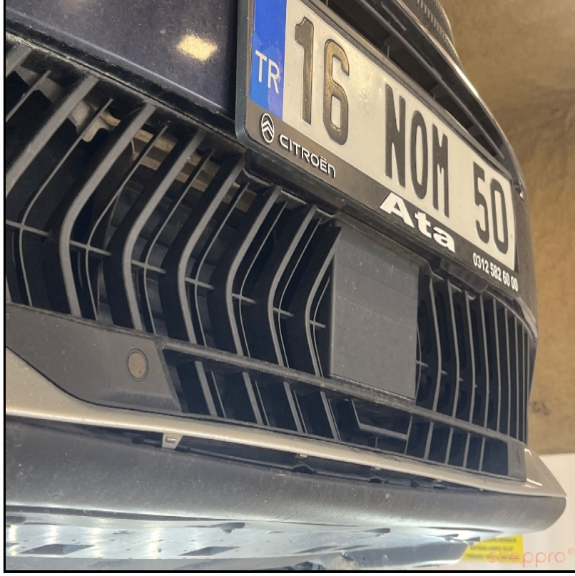
Ön tamponun alt kısmında deforme var
