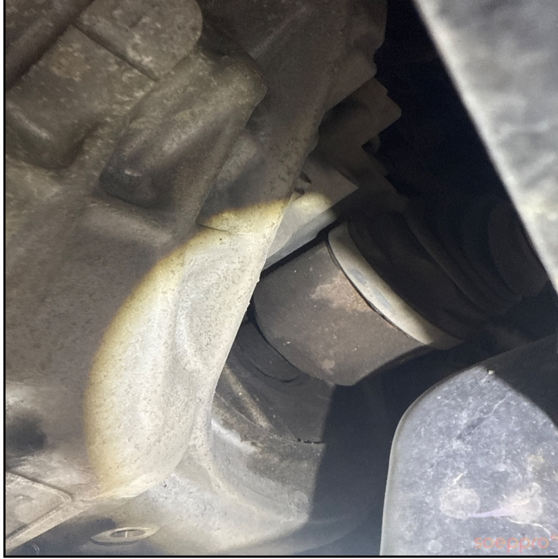
Sağ aks keçesinde yağ kaçağı var
