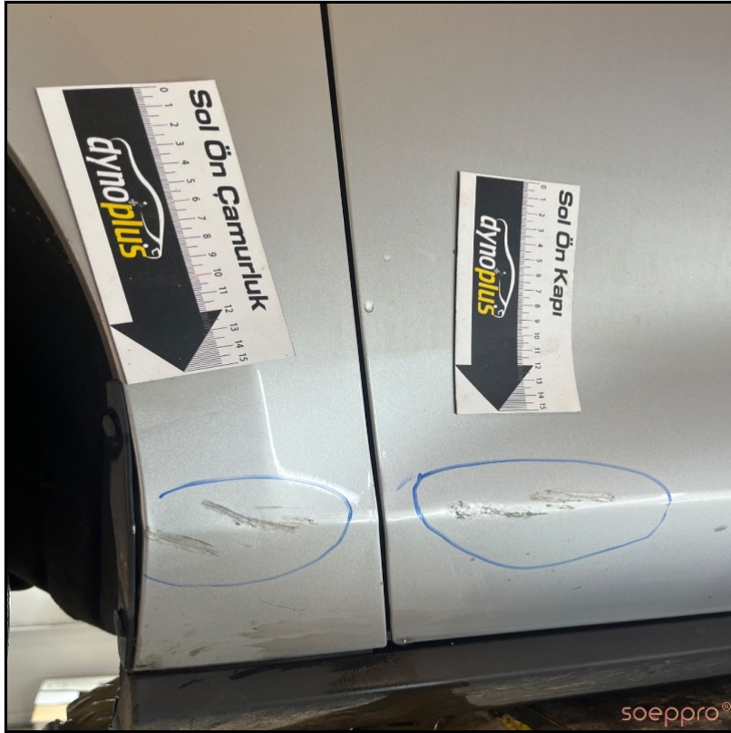
İşaretlenen bölgelerde kuru onarım var üzerine rutuş yapılmış
