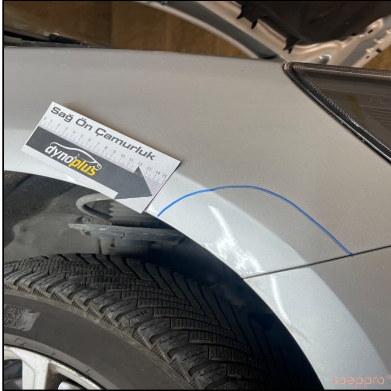
İşaretlenen bölgede kuru onarım mevcut
