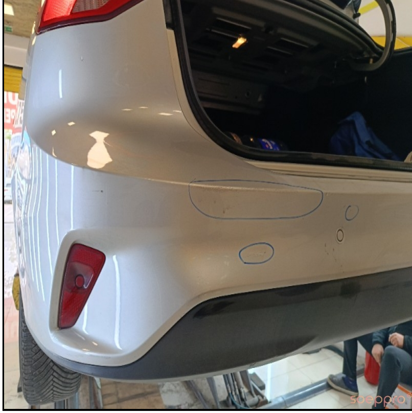
Arka tamponda deformeler ve rutuşlar var
