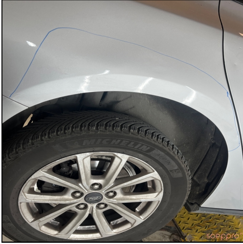
Sağ arka çamurlukta kuru onarım mevcut
