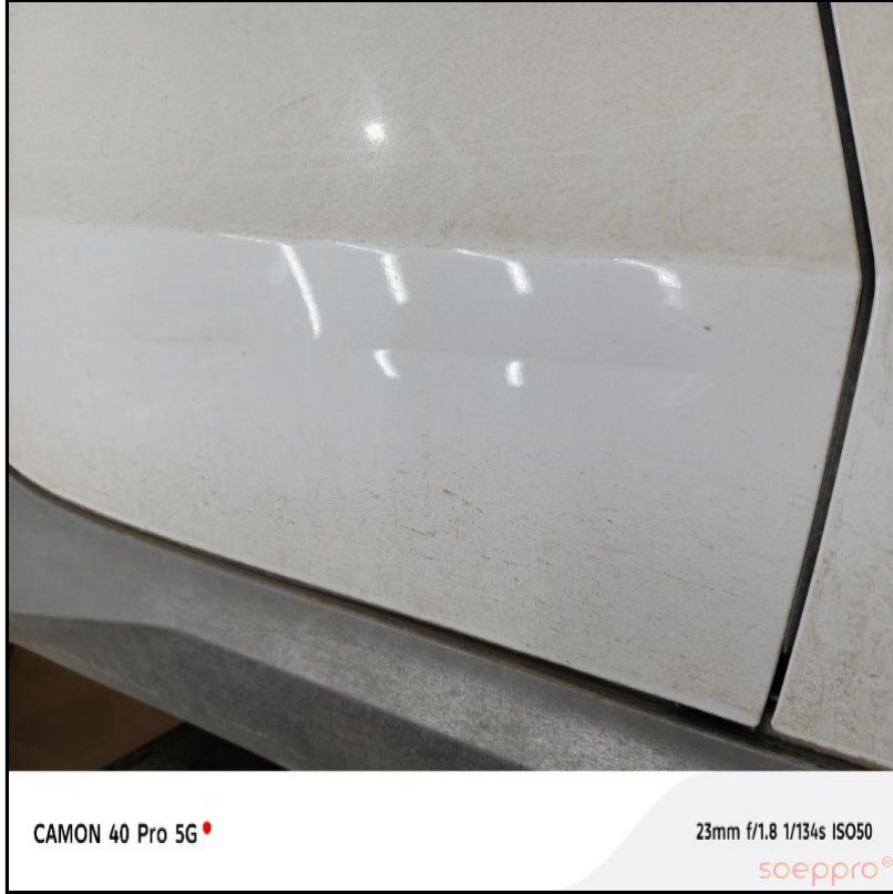
Sağ arka kapıda göçük var yoğun
