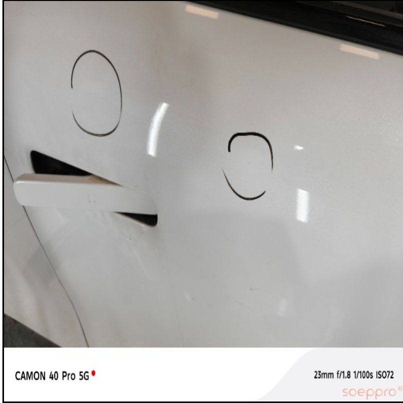
Sağ ön kapıda göçükler var
