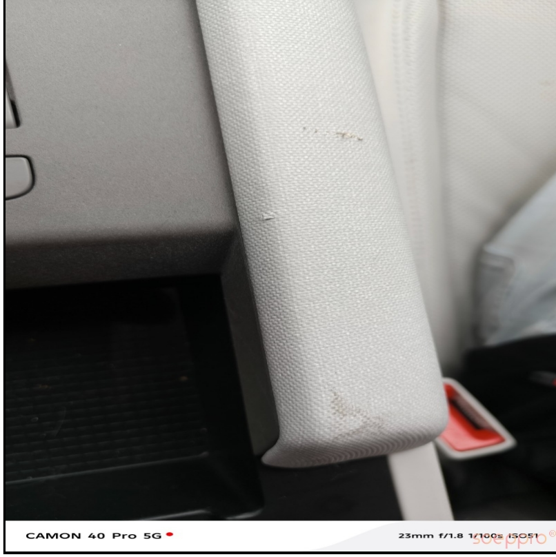
Kolçakta deformeler mevcut
