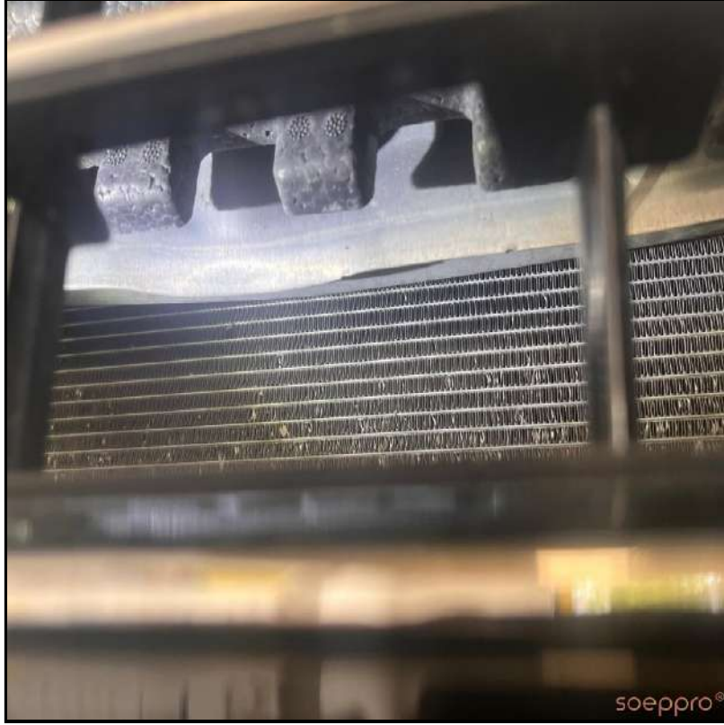
ÖN TAMPON DEMİRİ HASARLI
