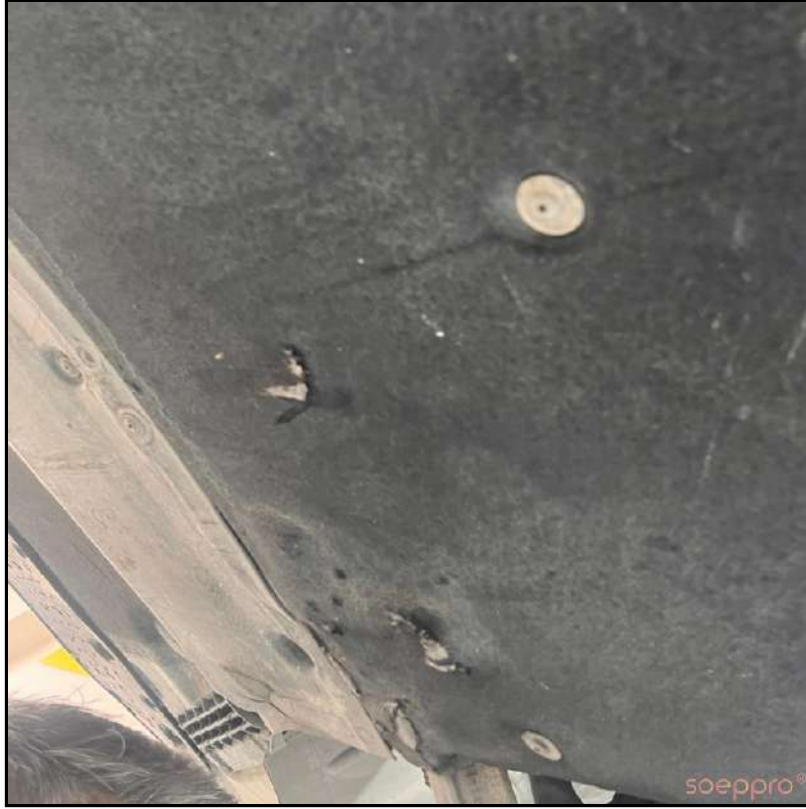
ALT MUHAFAZALARDA DEFORMELER VAR
