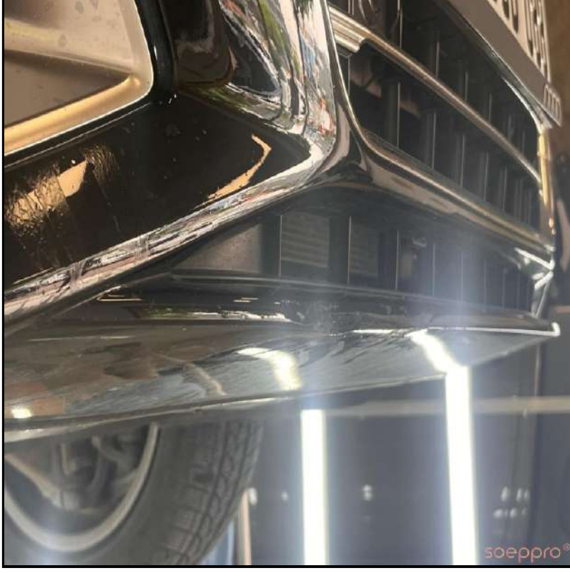
ÖN TAMPONDA DEFORMELER VAR
