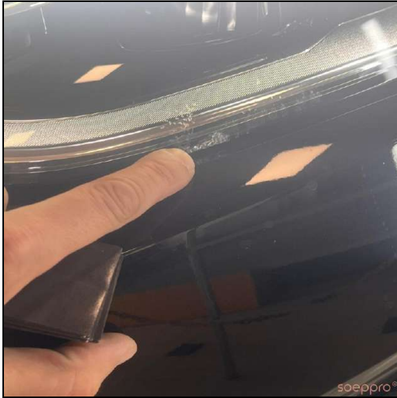
SOL ÖN FAR ALT KISMINDA KIRIK ÇATLAK VAR
