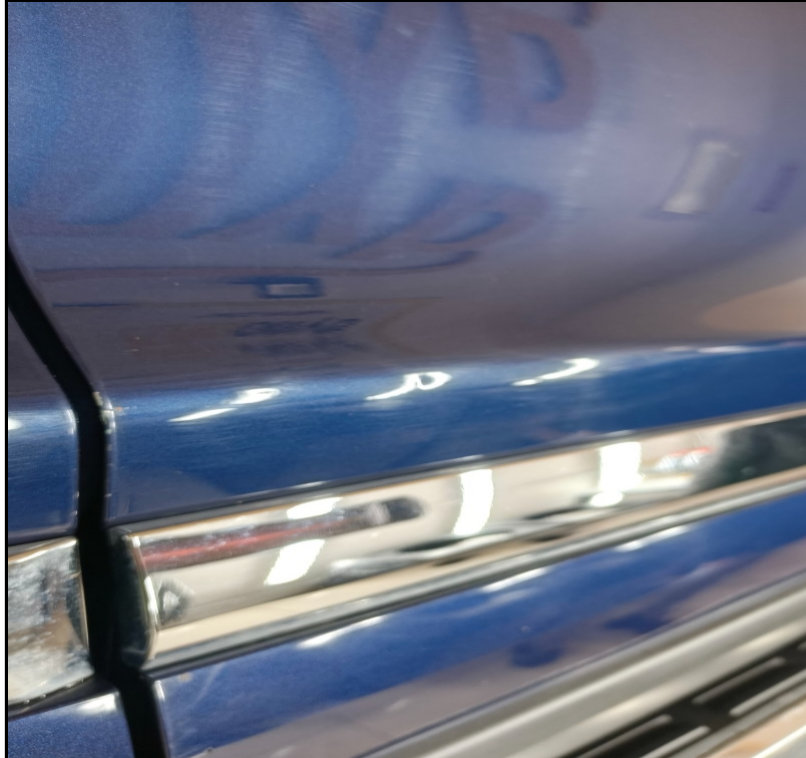
Sol arka kapıda göçük var
