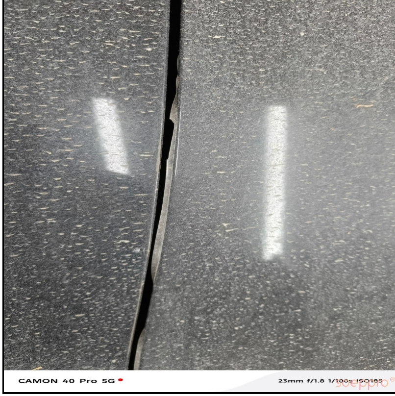
Sağ ön çamurluk kaplamasında deforme var
