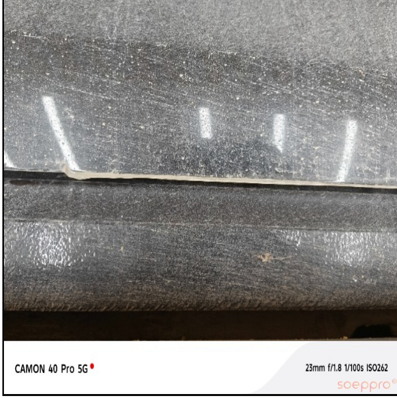
Sağ ön kapı kaplamasında deforme var
