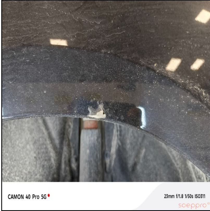
Sol arka çamurluk kaplamasında deforme var
