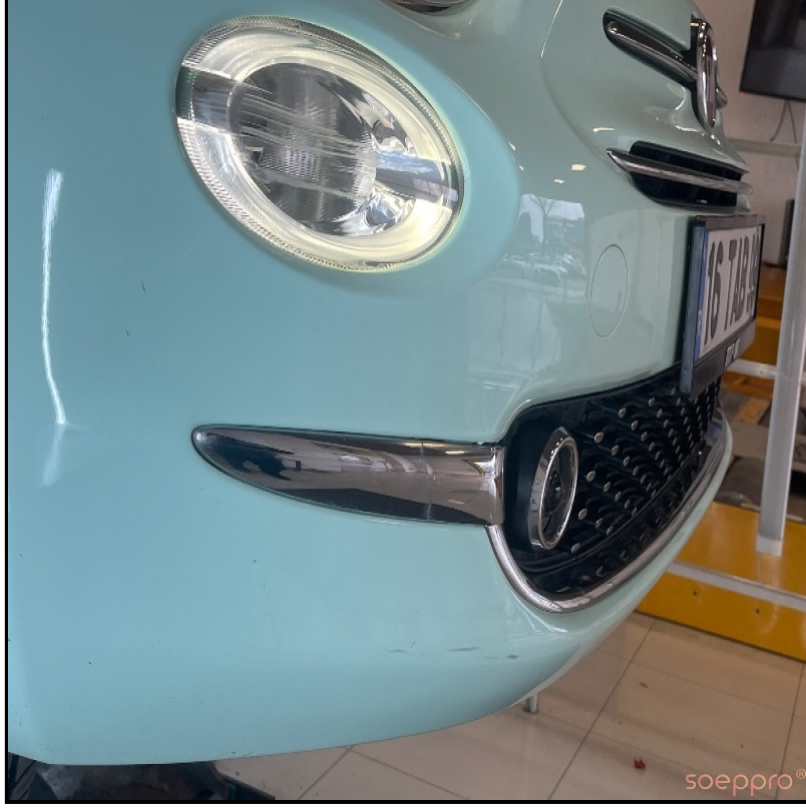
Ön tampon ve niklejlerinde deformeler var
