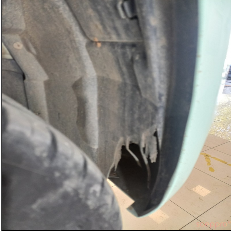
Sağ ön davlumbaz kırık
