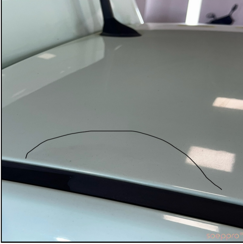
Tavanın sağ köşesine Hafif boya tozları kaçmış
