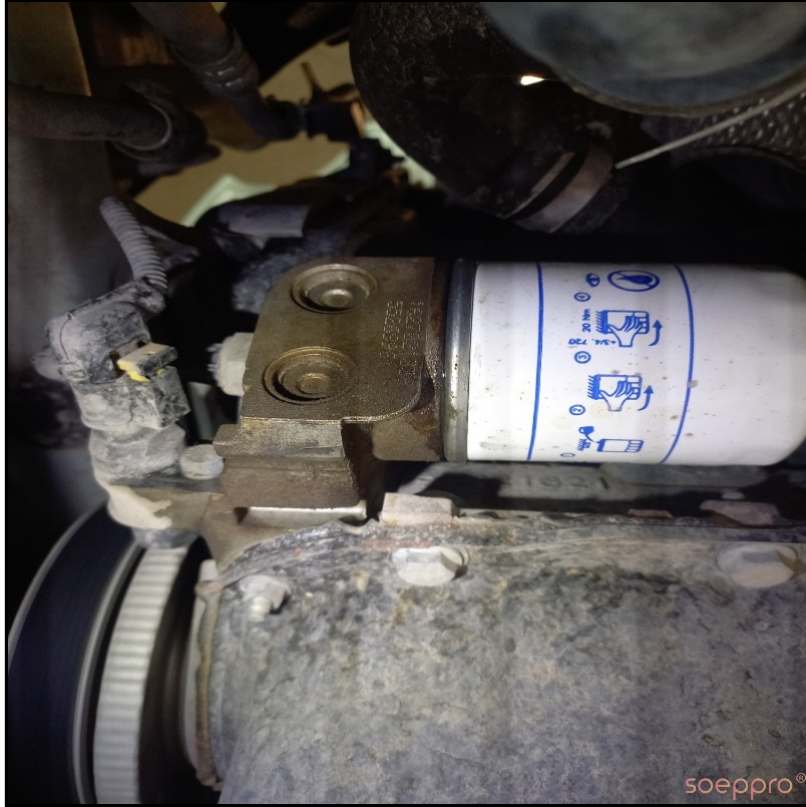
Yağ filtresinde yağ sızıntısı var
