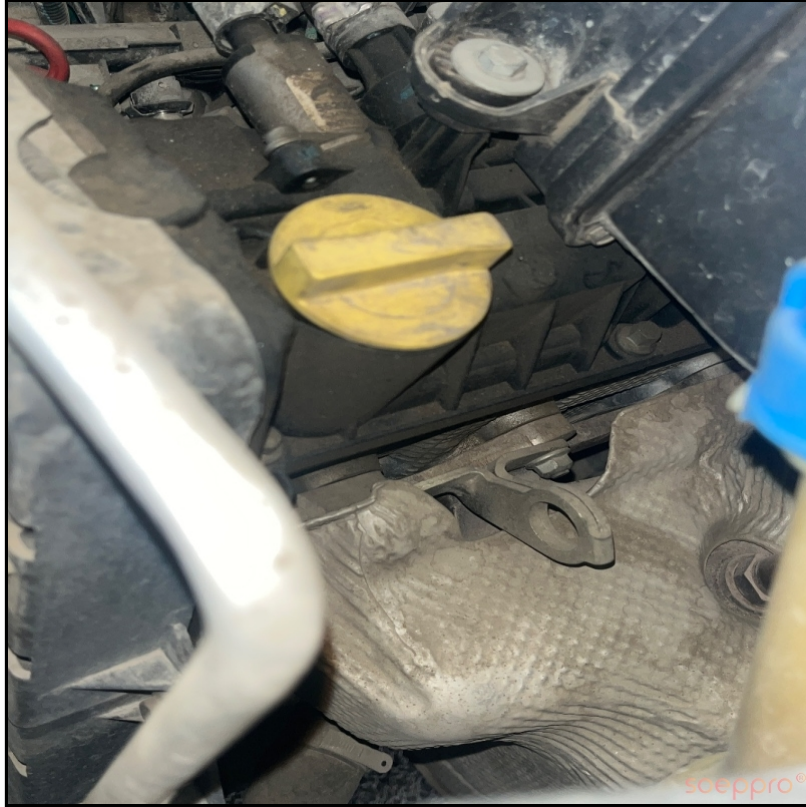
Motor üst bölgede yağ kaçağı var
