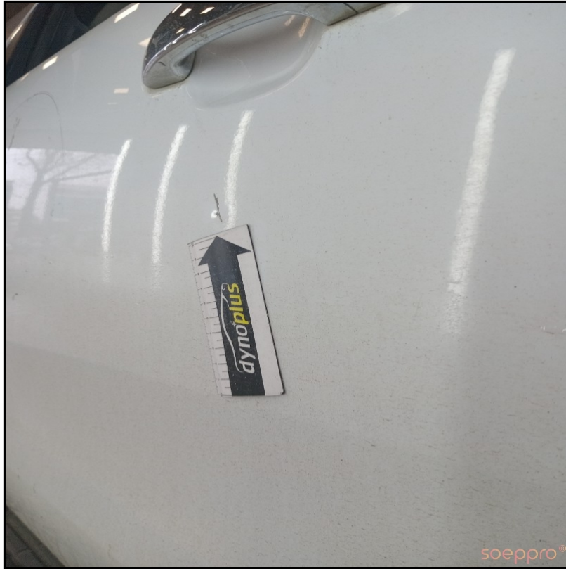
Sol ön kapıda göçük var
