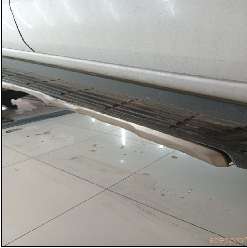
Sol basamak hasarlı
