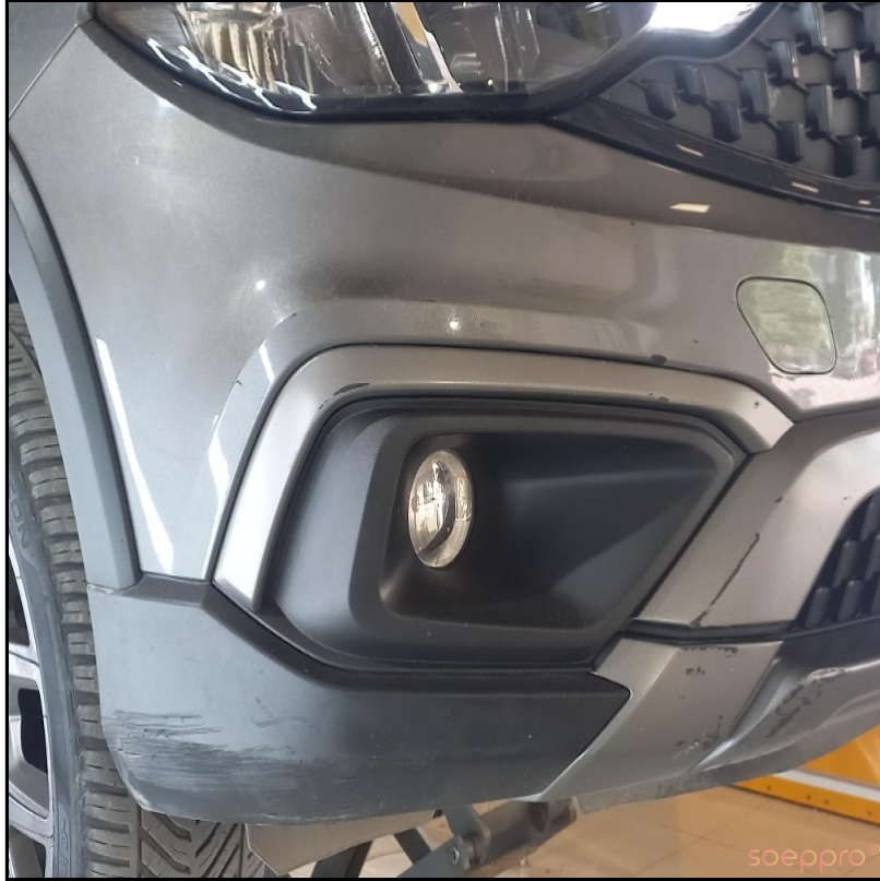
Ön tamponda deformeler mevcut
