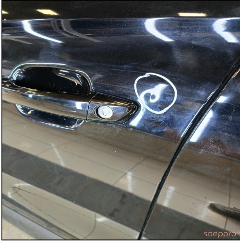
Sağ ön kapıda göçük var
