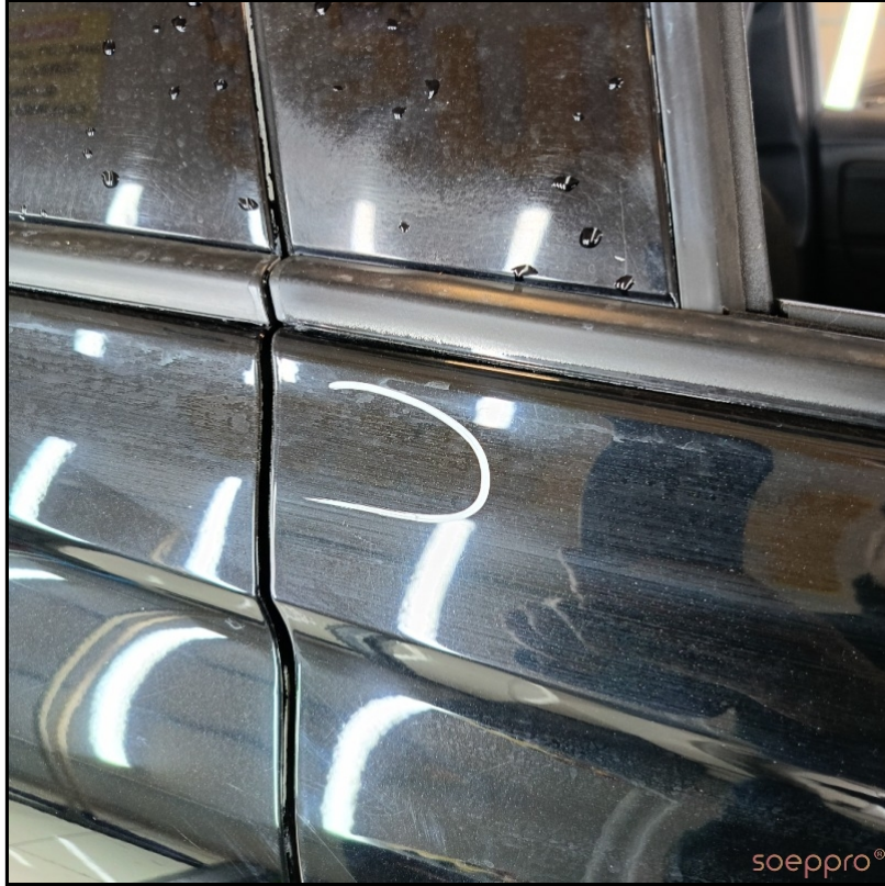
Sağ ön kapıda hafif göçük var
