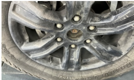
Jant göbeği kapağı, ön sağ > Sökülmüş-Yok
