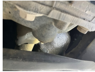
Motor, Motor > Yağ Kaçağı
