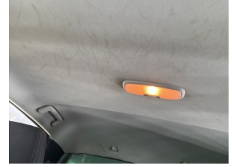
Döşemeler/Kapaklar, Tavan döşemesi > Deforme Olmuş
