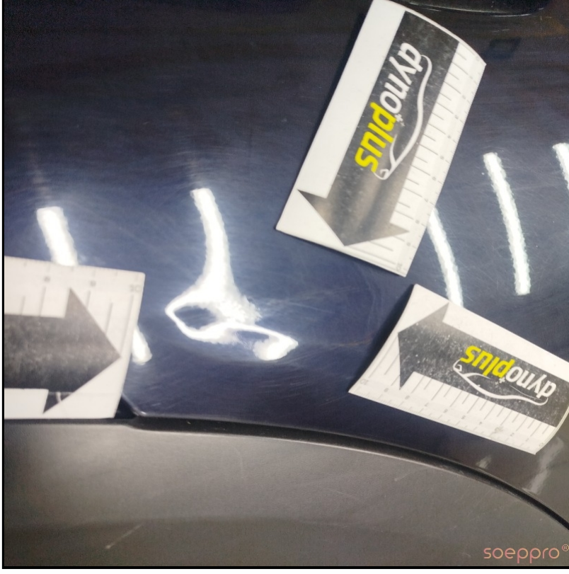
Sağ arka kapıda göçük var
