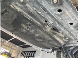
Motor, Alt muhafaza > Hasarlı
