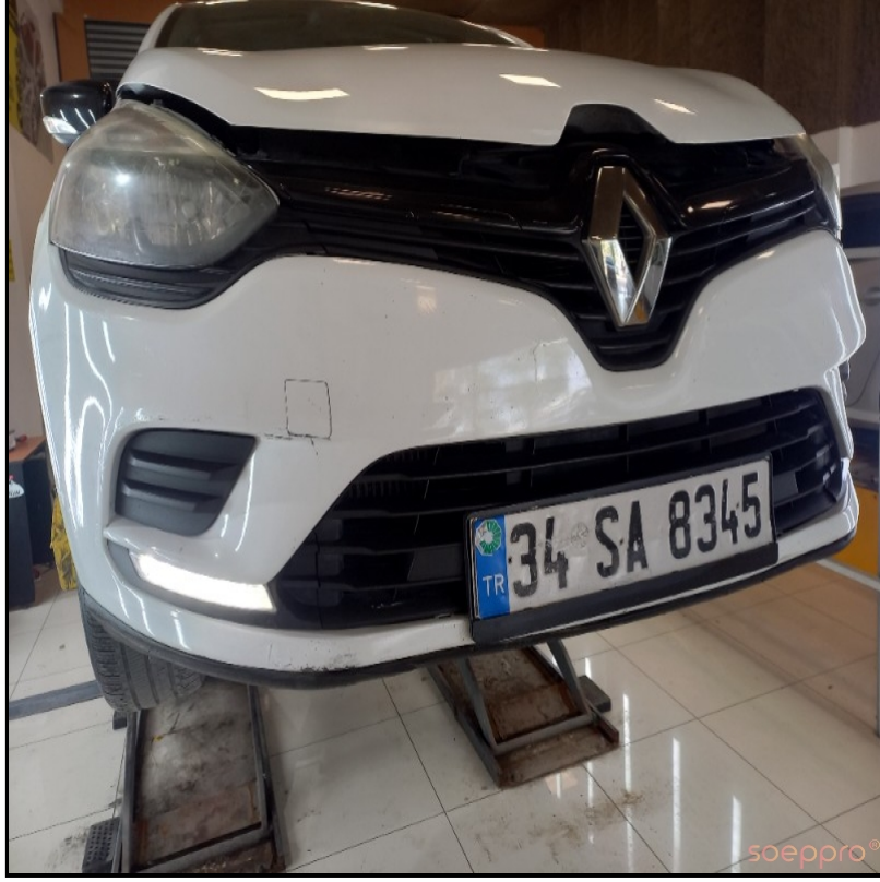
ÖN TAMPONDA DEFORMELER VAR
