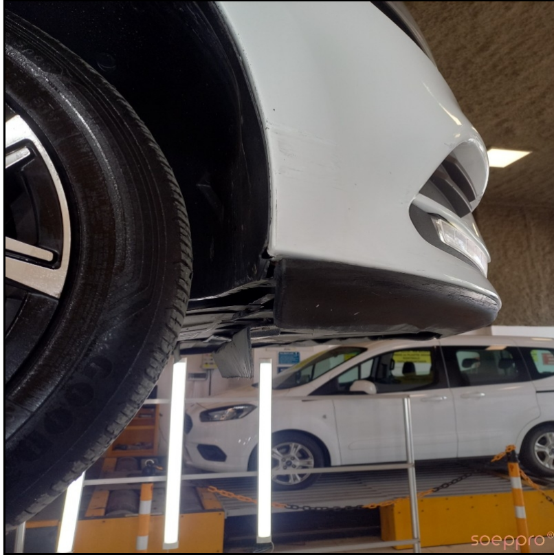
Ön tampon bağlantısında açıklık mevcut
