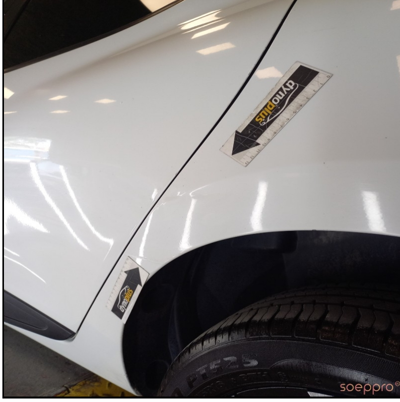
Sol arka çamurlukta Derin göçük mevcut
