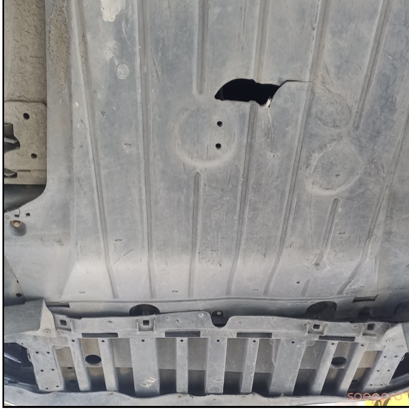
At muhafazalarda deforme mevcut
