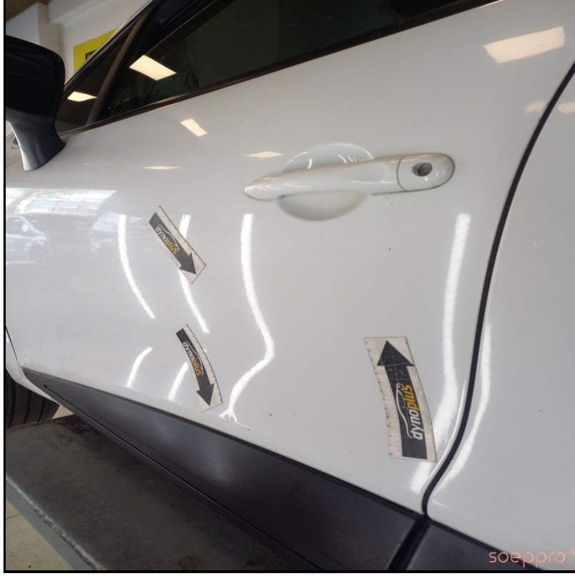
Sol ön kapıda göçük mevcut
