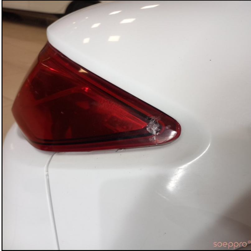
SAĞ ARKA STOPTA DEFORME MEVCUT
