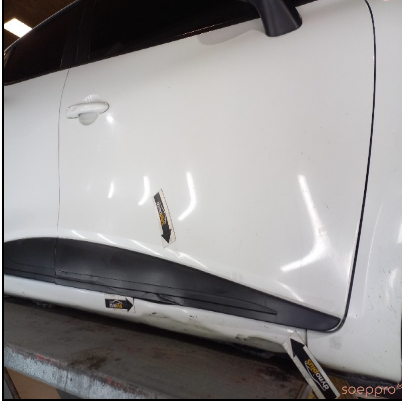
Sağ Marşpiyel de hasar mevcut sağ ön kapıda göçük mevcut
