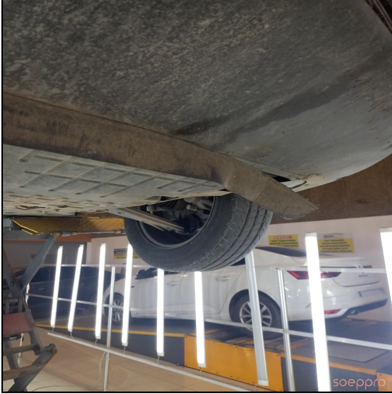
plastik muhafazalar hasarlı
