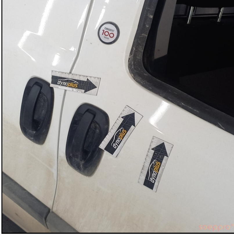
Sağ ön kapıda Gamze göçükler var
