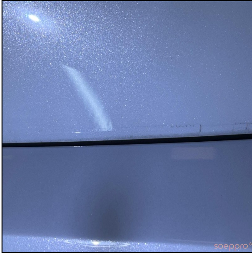
Sağ ön cam direğinde vernik atıkları var
