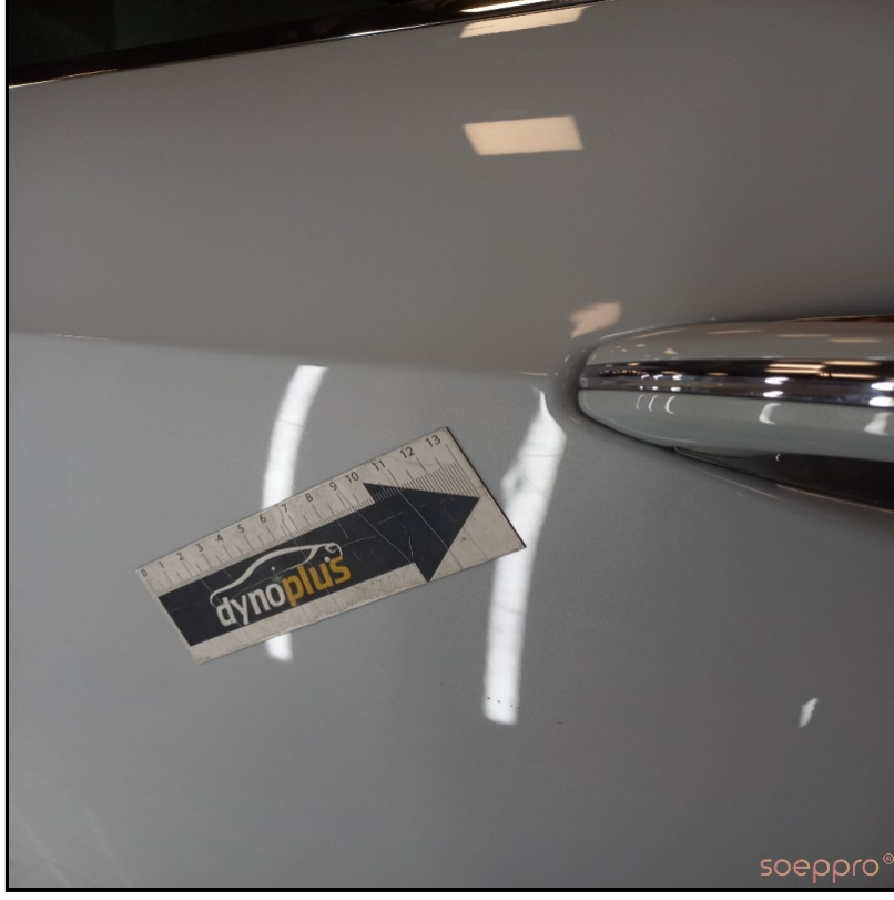
Sol ön kapıda göçük var
