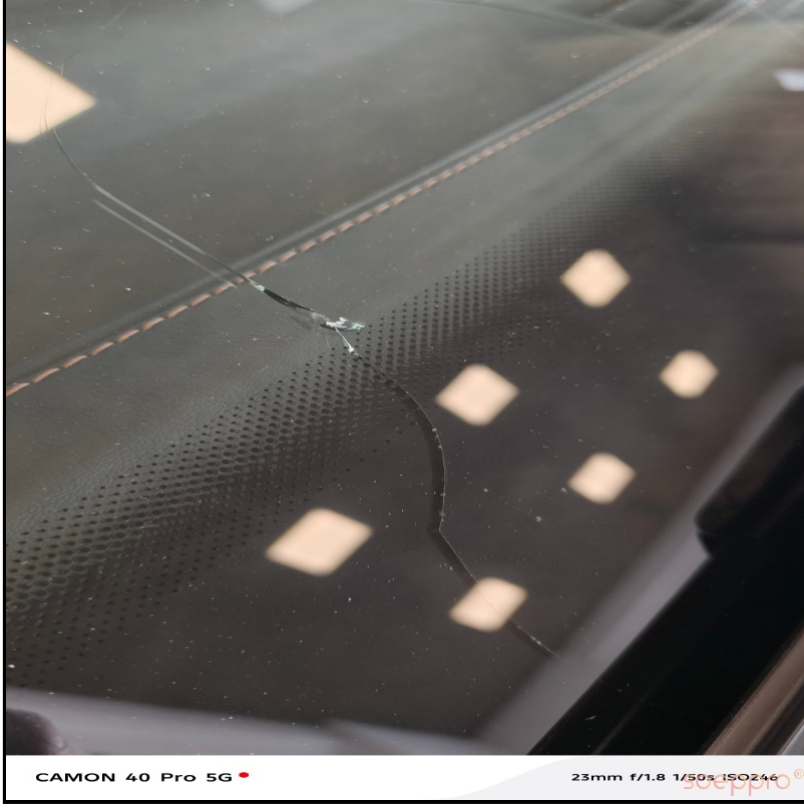
Ön cam çatlak
