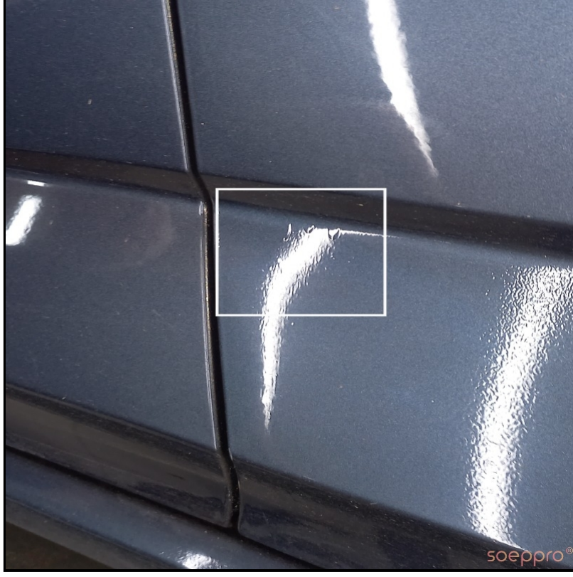
Sağ ön kapı hatalı boyanmış boya akıntıları var
