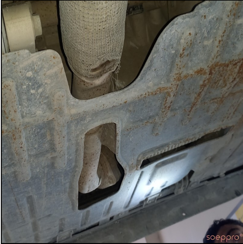
Egzoz spirali hasarlı
