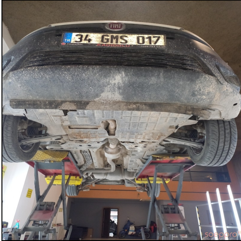
Aç muhafazalarda deformeler var tabanda yoğun çamurluğu var
