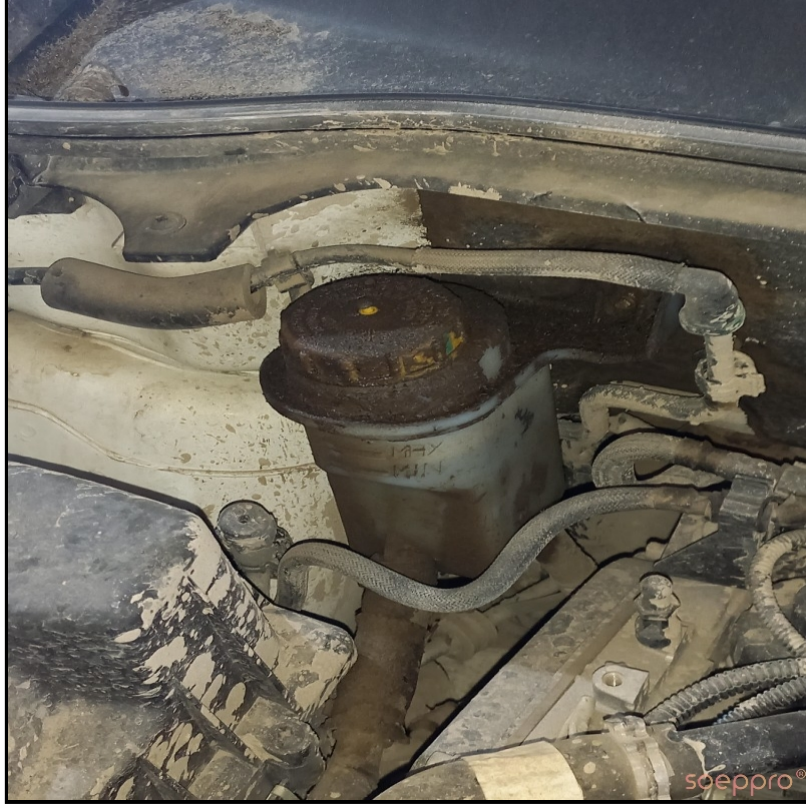
Direksiyon hidrolik deposunda Sızıntı var
