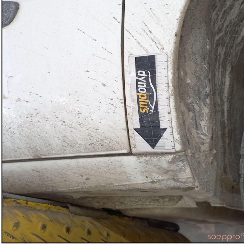
Sağ Marşpiyel ucu hasarlı
